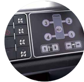
Steering control panel 转向控制面板
